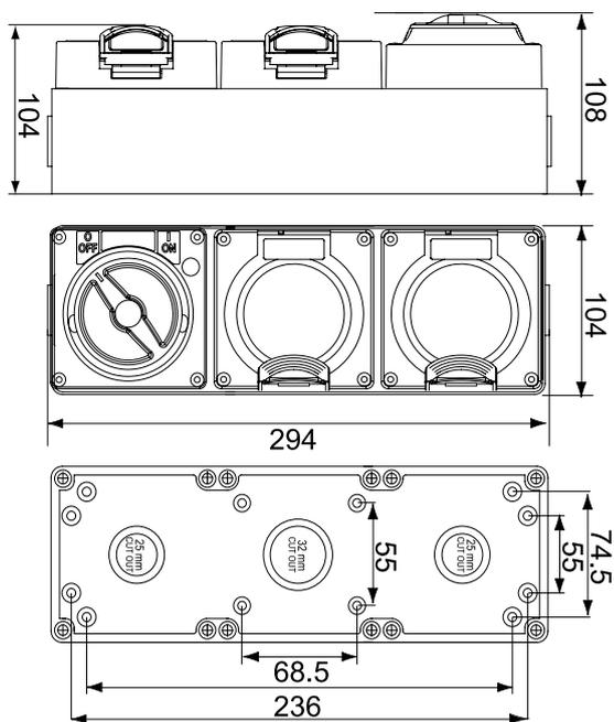
10A/16A 带开关两位防水插座尺寸
