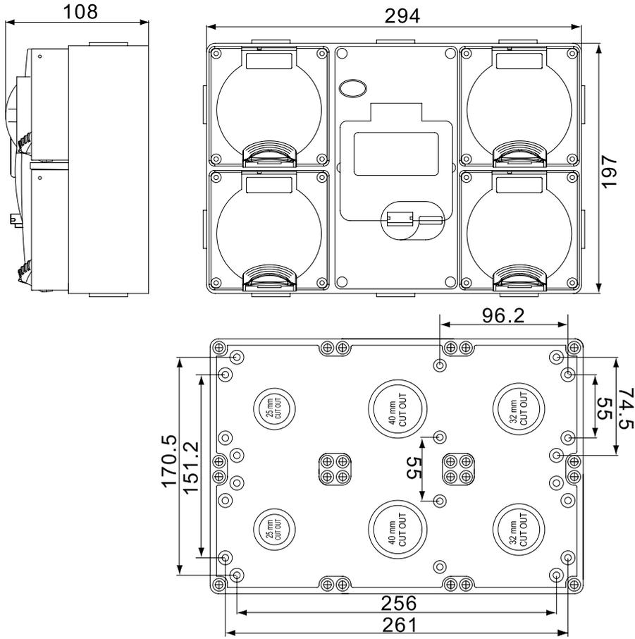
16A+10A 带漏电保护开关组合式防水插座尺寸
